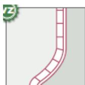
Bordillos para proporcionar la separación vertical entre espacio de calzada peatonal del estacionamiento, protegiendo a los peatones de los vehículos. La altura del bordillo debe ser de 150 mm desde el canal hasta la parte superior del bordillo.
