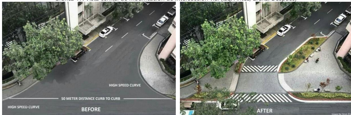
Gráfica 17. Vista cenital de modificación de intersección vial (izq. Antes, drcha. Después)
