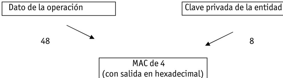
Función MAC (Message Authentication Code) del algoritmo DES (Data Encryption Standard) según norma ANSI X.9.9
